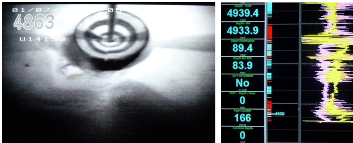
Cône d'entrée du puits 345 U1415 P par 4863 mètres de fond et suivi de l'avancée du forage dans le puits
