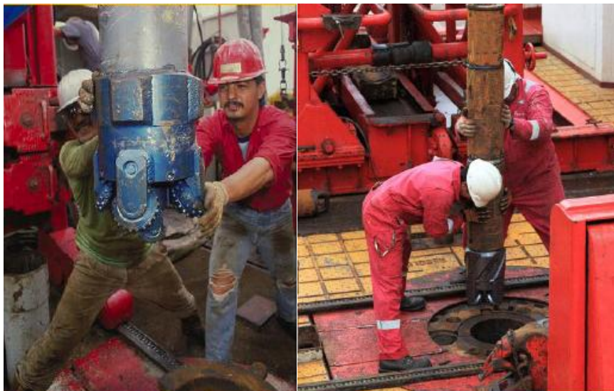
Installation du trépan à l'extrémité des tiges de forage
