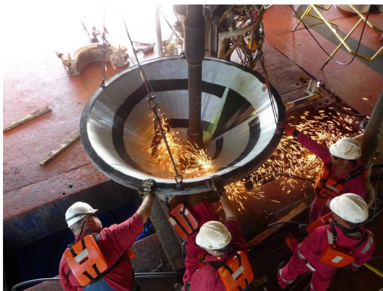
Fig 7 : Le cône d'entrée du futur puits de carottage assemblé puis descendu par la 'Moon Pool'
