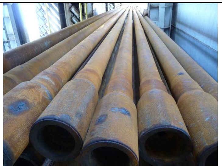
FIG 2 : Tiges de forage 7 500 m de tiges de forage d'un diamètre de 13 cm
