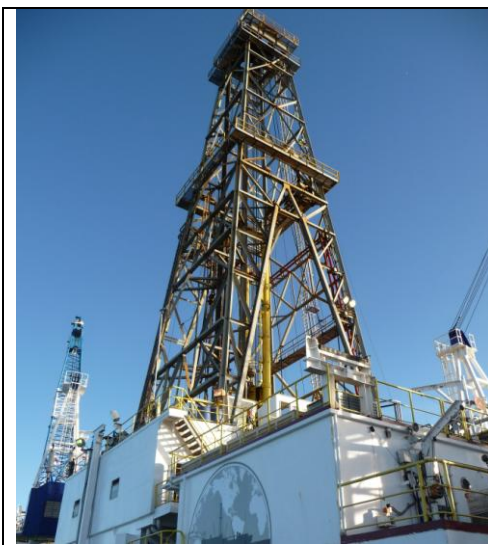
FIG 1 : Derrick 45 mètres de haut
